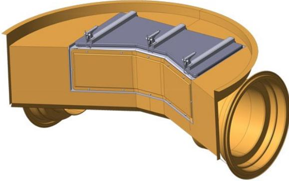
Das Unterteil ist ein versetzfertiger Schacht mit mittig oder außermittig durchgeführtem Gerinne.
