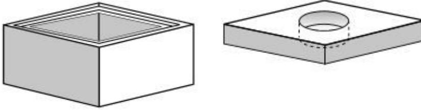
Fertigteile mit Falzverbindung, eckige Teile sind nicht in der DIN enthalten.
