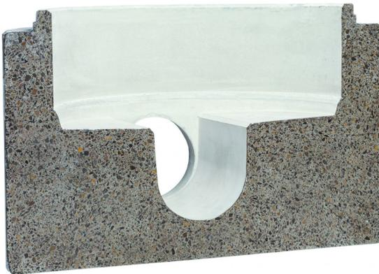
Fest in der Muffe einbetonierter Dichtring aus Elastomeren mit angeformtem sandgefülltem Lastausgleichsschlauch für das ecorSchachtsystem.
