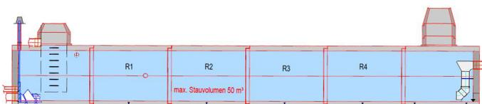
Stauraumkanal mit integrierter Drossel in nasser Aufstellung
