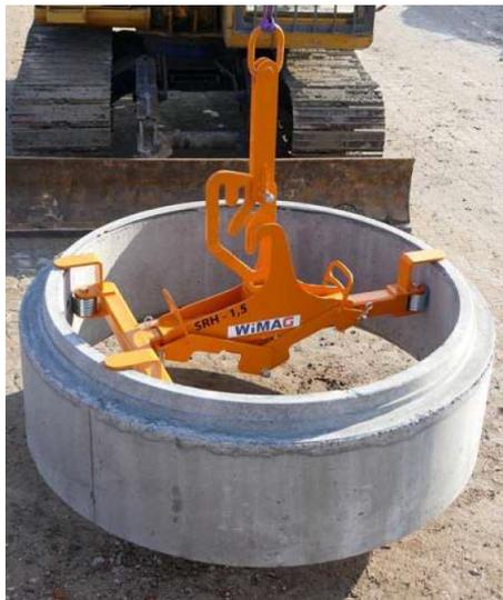
**Bild 8: Schachtheber (WIMAG)**
