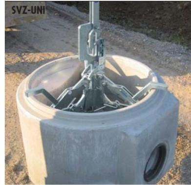
**Bild 7: Schachtversetzzange (Probst)**
