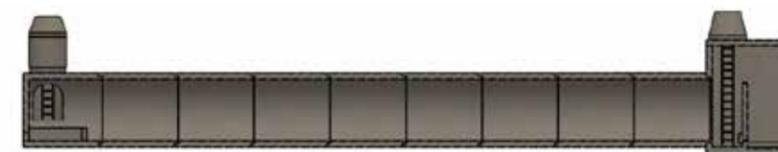
Stauraumkanal mit separatem Drosselbauwerk und Drosselkammer für halbtrockene Drosselgeräte
