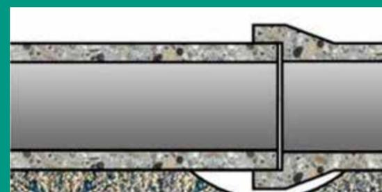
Expositionsklasse XA3 als next.beton Stahlbetonrohr
