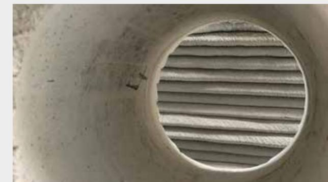
Kernbohrung durch ein 3D gedrucktes Bauteil.
