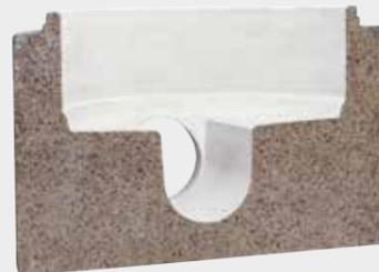
Fest in der Muffe einbetonierter Dichtring aus Elastomeren mit angeformtem sandgefülltem Lastausgleichsschlauch für das ecoRÖSER-Schachtsystem.
