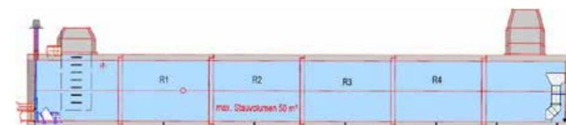
Stauraumkanal mit integrierter Drossel in nasser Aufstellung
