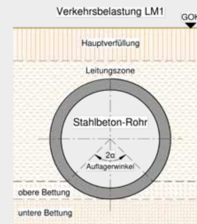
Bei biegesteifen Rohren kann die horizontale Stützung im Vergleich zum Norm-Ansatz reduziert werden, ohne hierdurch die Trag- und Standsicherheit zu gefährden. Eine geringere vorhandene Verdichtung der Leitungszone gegenüber dem Norm-Ansatz wirkt sich also nur geringfügig aus. Statische Sonderlösungen für den normabweichenden Einbau sind möglich und können projektbezogen erstellt werden.
