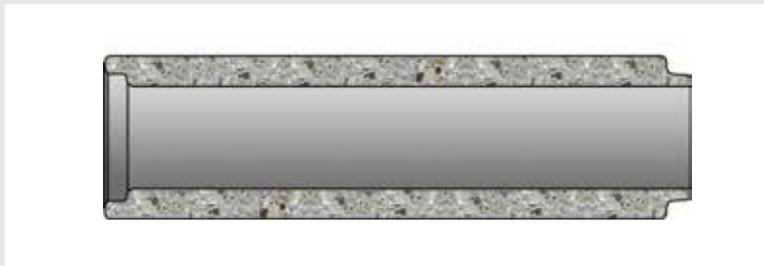
ROBUST®-Rohr mit Dichtung ROBUST®
